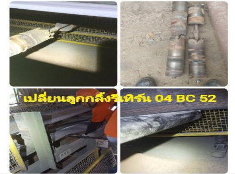
ตรวจสอบหน้างานเปลี่ยนลูกกลิ้งรี เทิร์น สายพาน 04BC52
